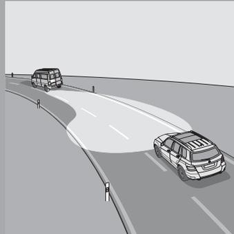
Dank ILS wird der linke Fahrbahnrand bei Bedarf heller und weiträumiger ausgeleuchtet.
